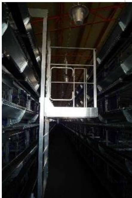
Figura 5 - Dispositivi per ispezionare le gabbie
